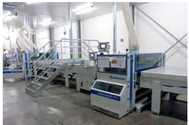
Sparte Fußboden der Tochterfirma Interdomus geht. Fast zwei Jahre beschäftigte sich AV Design intensiv mit dem „Hot Coating“-Verfahren und investierte kräftig in Gebäude und Produktionsmittel. Die 120 m lange Produktionslinie in U-Form nimmt eine eigene Halle ein. In dieser wiederum gibt es eingehaute Bereiche, um eine möglichst staubfreie Umgebung zu gewährleisten.
