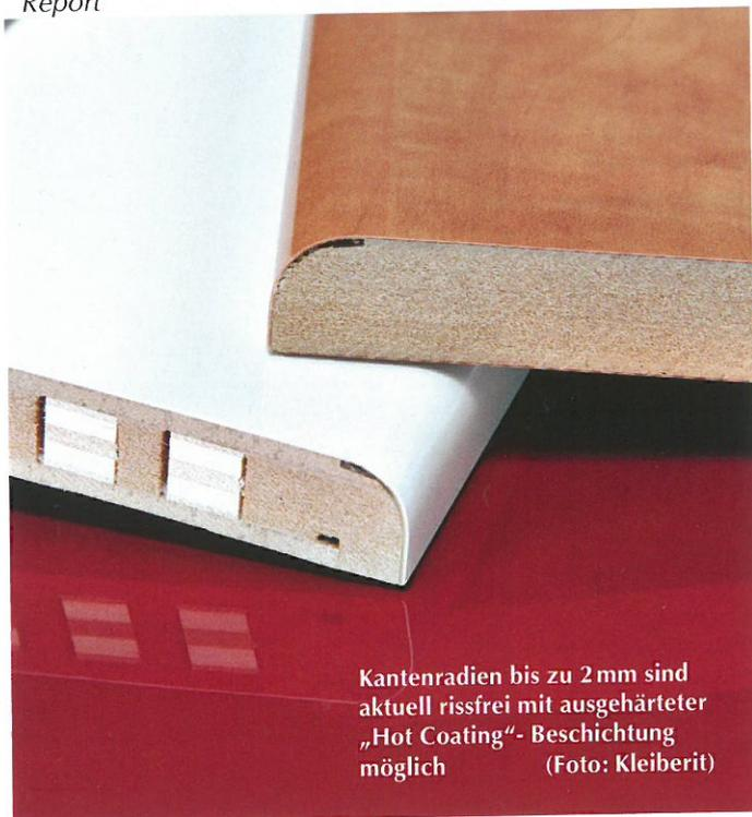
Kantenradien bis zu 2 mm sind aktuell rissfrei mit ausgehärteter „Hot Coating“-Beschichtung möglich (Foto: Kleiberit)
