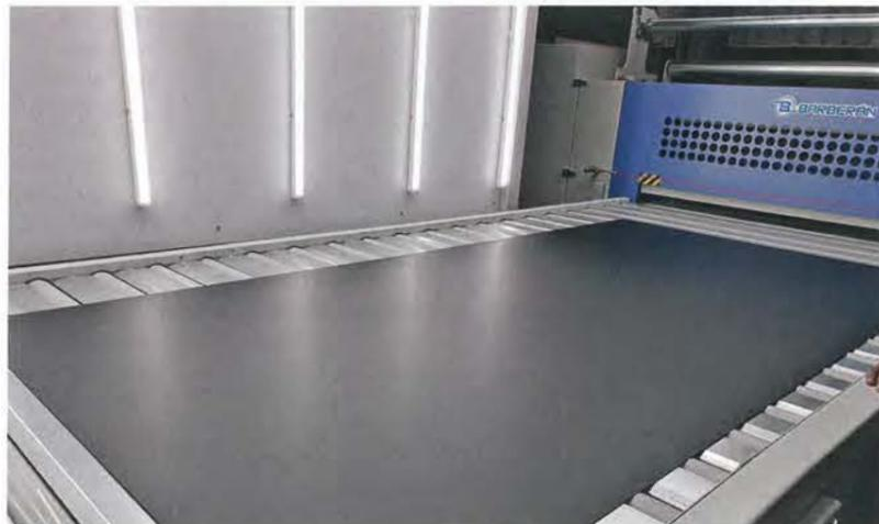
Supermatte „Hot Coating“ Fläche nach dem Härten beim Verlassen der Anlage
