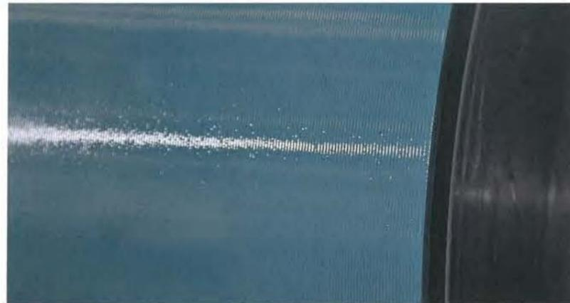
Speziell gerillte und bis 160°C beheizte Auftragswalzen erlauben hohe Auftragsmengen und eine gleichmäßige Verteilung über die gesamte Fläche
